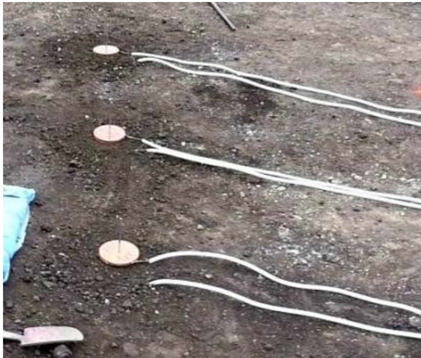
Fotografia 2 Podłączenie czujników (EMU) w warstwie podłoża
