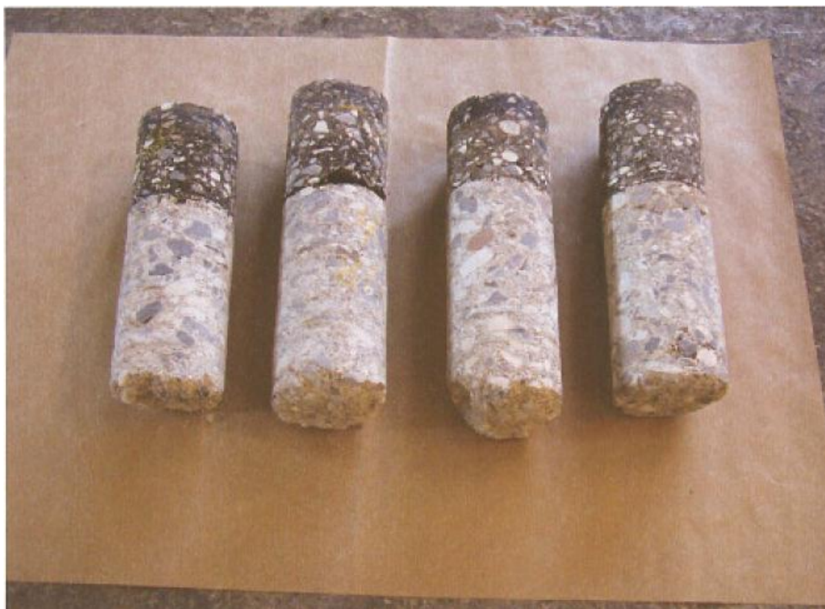
Rysunek 6. Odwierty z nawierzchni półsztywnej M3 obwodnica Kopenhagi, Dania
